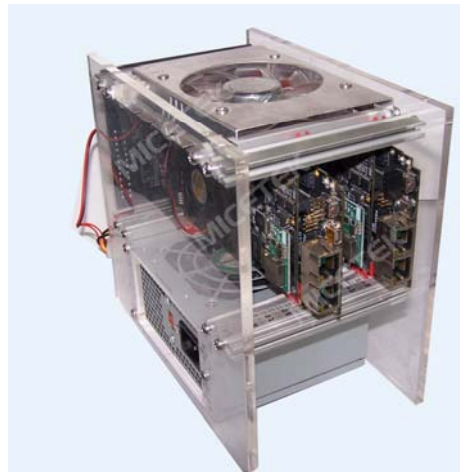
UTCA系统（带两套MT85XX-A开发板）
